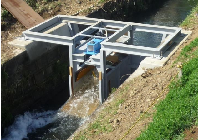
実験中の清流発電装置
